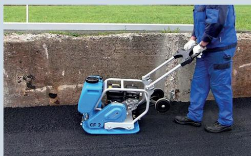
**Série CF** - Placas vibratórias monossentido; Três modelos, dos 70 aos 113 kg, com bases de 40 a 67cm de largura
