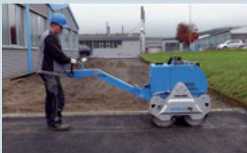
**Série DVH** - Cilindros vibratórios de rolo liso para compactação de asfaltos, ciclovias, parques, etc. Dois modelos, 420 e 732 kg.
