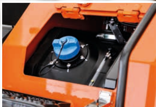
A injeção de ureia nos gases de escape reduz as emissões.
