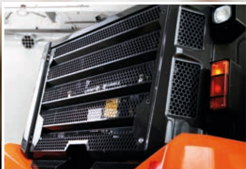
A nova grelha traseira protege o compartimento do radiador.
