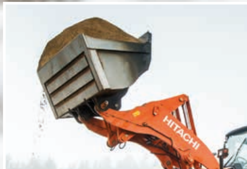
O sistema de controlo do fluxo garante o movimento suave do braço de elevação.
